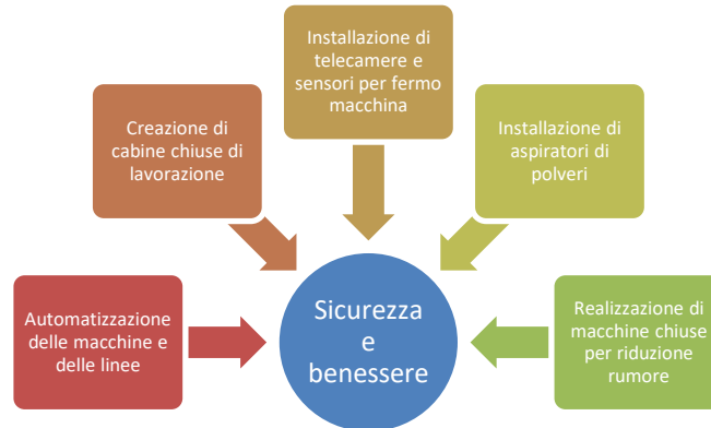
Figura 8: Linee di azione per il benessere e la sicurezza d'uso dei macchinari
